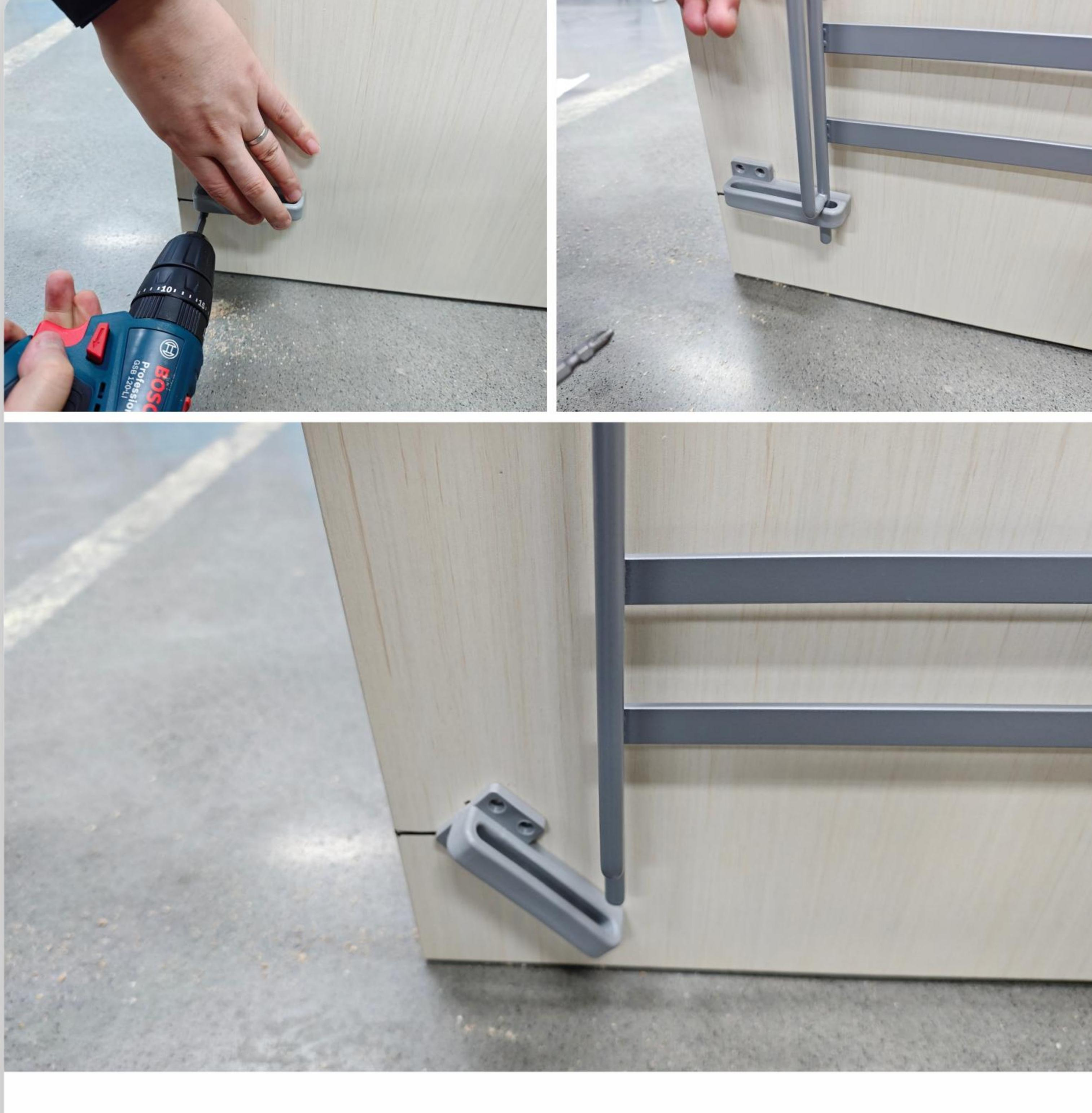
安装导向槽支架，对准预钻孔装好底部导向槽支架，先装第一个螺丝，再旋转导向槽支架将收纳架框架对准导向槽，再固定第二个螺丝。
