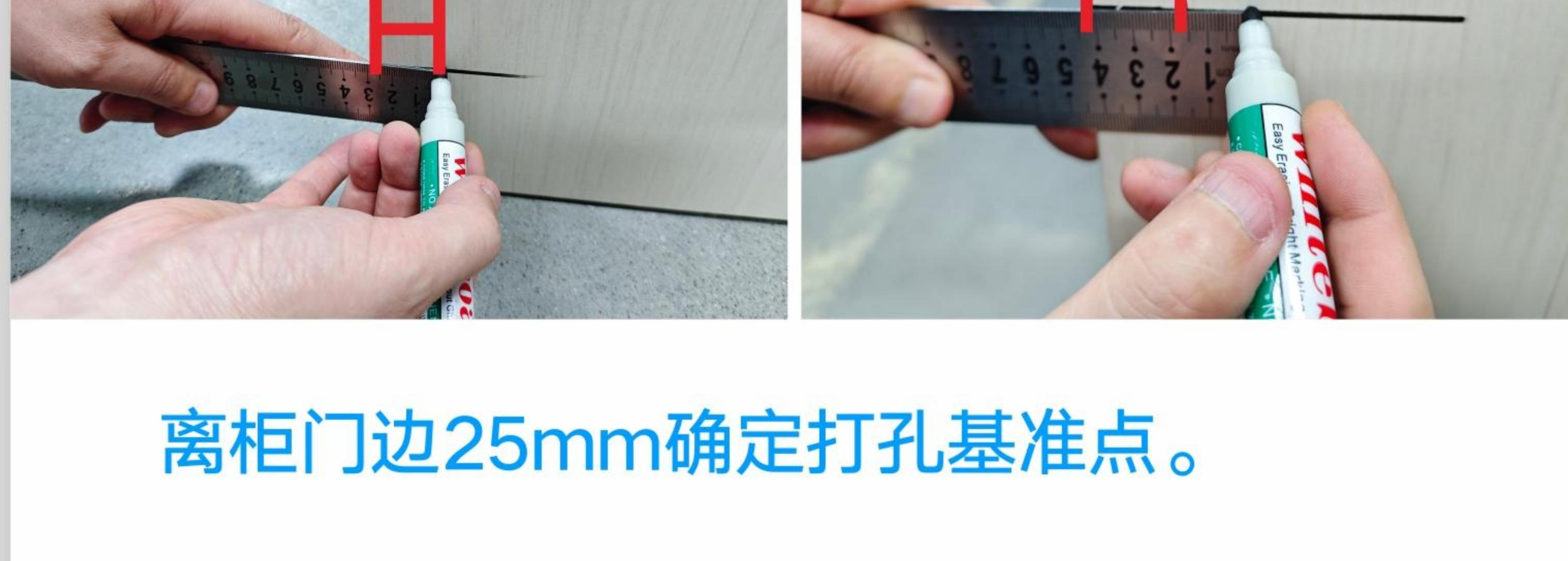
离柜门边25mm确定打孔基准点。
